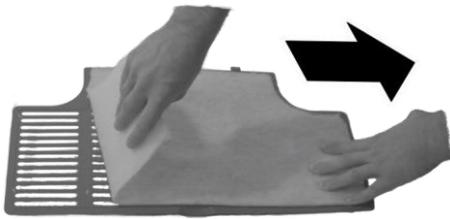
Abb. 29: Reinigungsfilter abziehen
