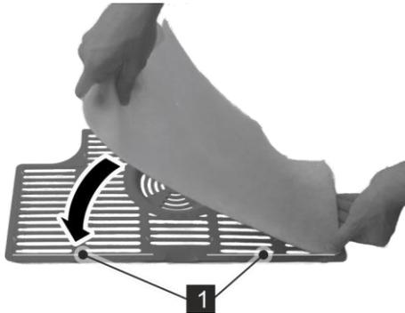
Abb. 30: Reinigungsfilter aufkleben
