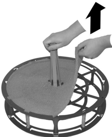
Abb. 24: Inneren Verdunstfilter entfernen
