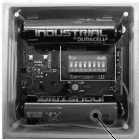
Abb. 8: Batterien einsetzen
