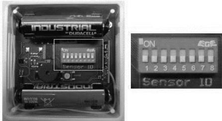
Abb. 12: Luftbefeuchter codieren
